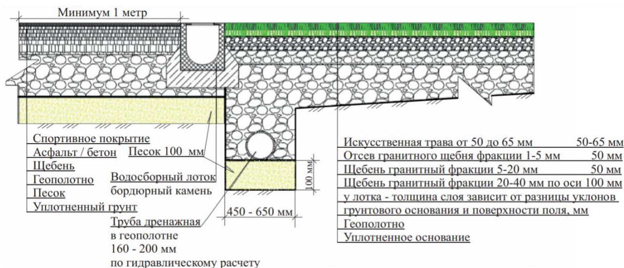
Рисунок 1 – Конструкция спортивной площадки
