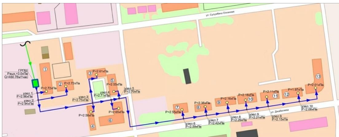
Рис. 1. Результаты гидравлического расчета сети низкого давления
