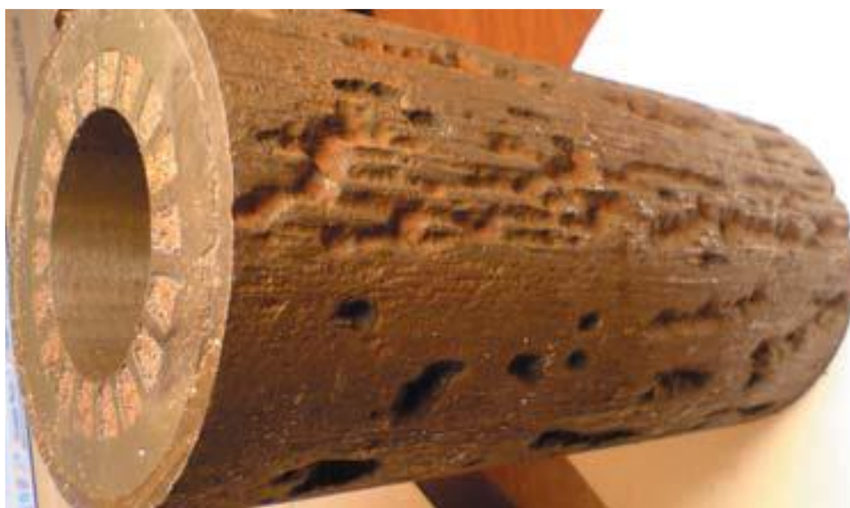
Рис. 12 – Язвенно-канавочная коррозия корпуса ПЭД (Барсуковское месторождение)
