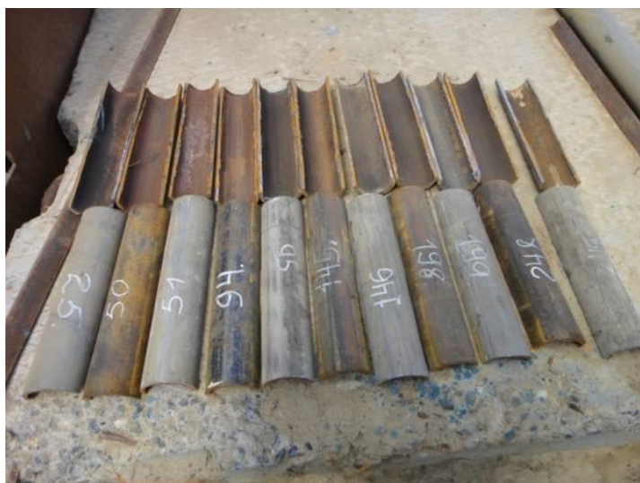
Рис. 2 – Внешний вид «катушек» из НКТ из скв. 108
