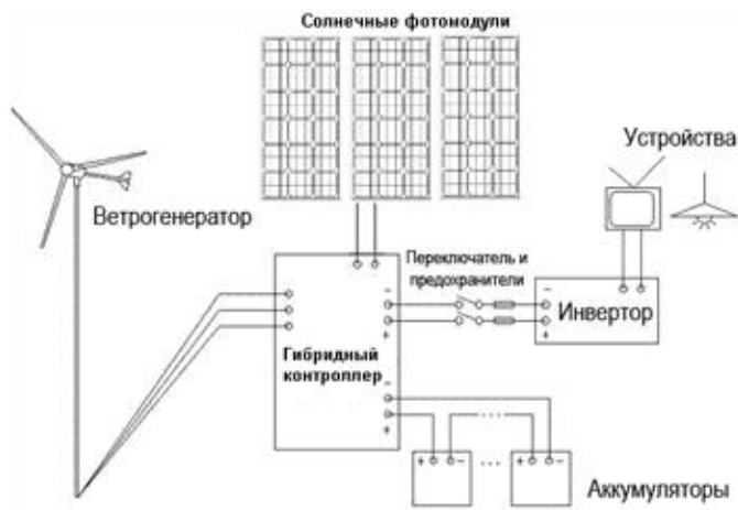
Рисунок 2 - Схема гибридной станции состоящей из солнечных модулей и ветрогенератора.
