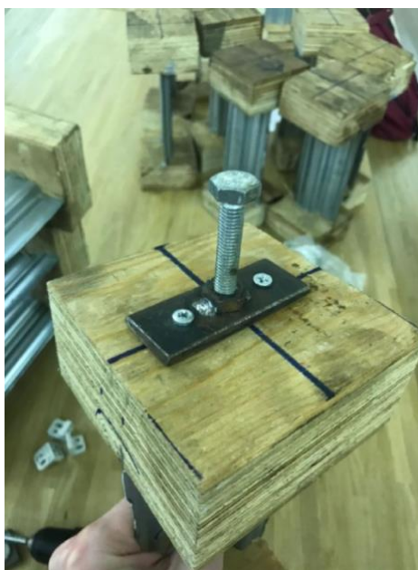
Рис. 2.2.1. Крепление пластин и шпильки к испытываемому образцу
