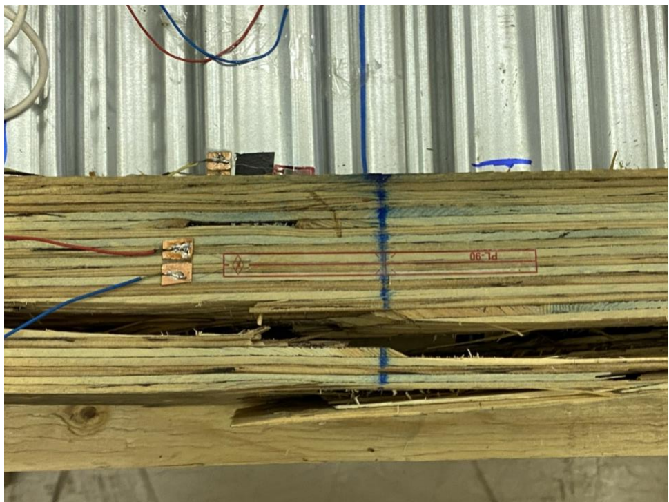
Рис. 2.1.11. Разрушение нижней полки балки №2
