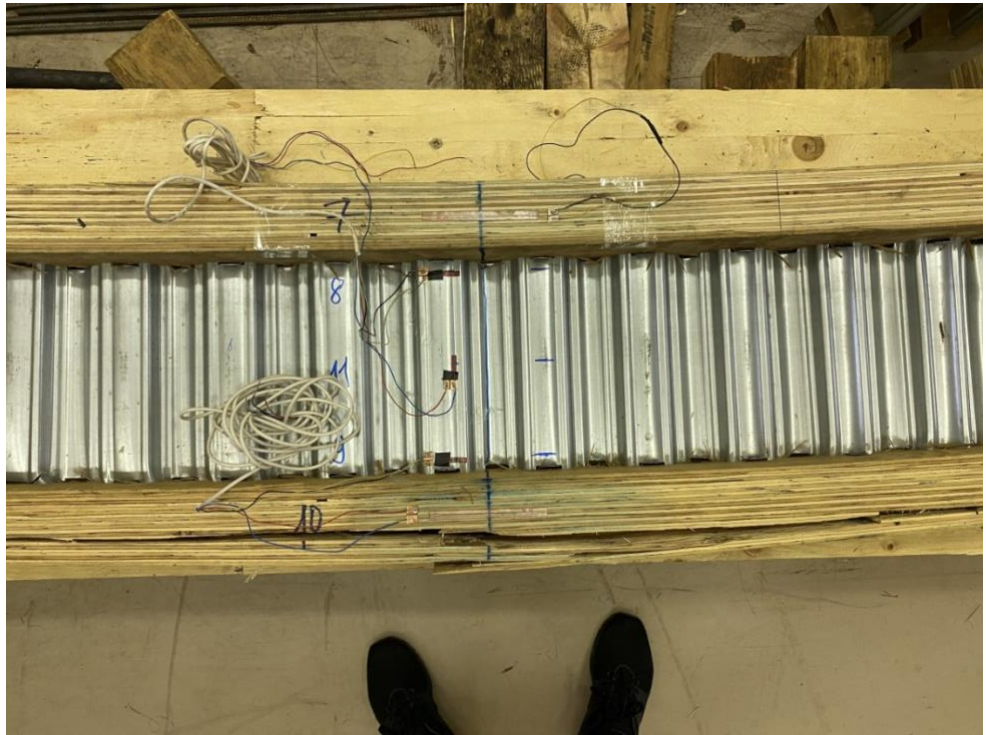
Рис. 2.1.10. Общий вид балки №2 после проведения испытания
