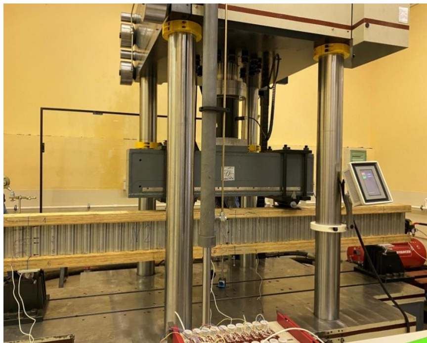
Рис. 2.1.9. Установка балки №2 на испытательный стенд
