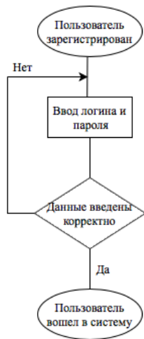
Рисунок 8 – Схема алгоритма входа в систему
